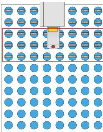
Das große Laserfeld ermöglicht das zeitgleiche Drucken von Ablaufdaten auf mehrere Deckel
